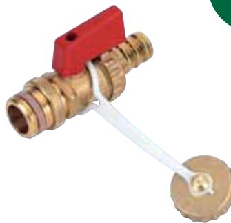
**Mini scarico caldaia giallo sabbiato con leva nylon, teflon sul filetto 1/2", controdado, girello e portagomma**
